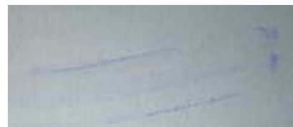
Si l'encre peut être effacée, la surface est de bonne qualité.
