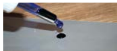
Test de l'encre : versez une goutte d'encre sur la surface anodisée et nettoyez-la avec un tissu absorbant.
