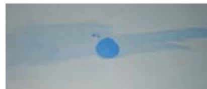
S'il reste de l'encre, la surface est de qualité inférieure.
